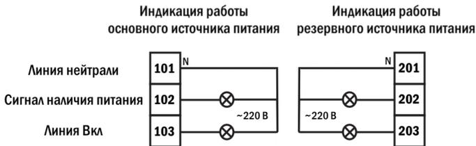
Рис. 7 – Схема подключения внешней индикации
